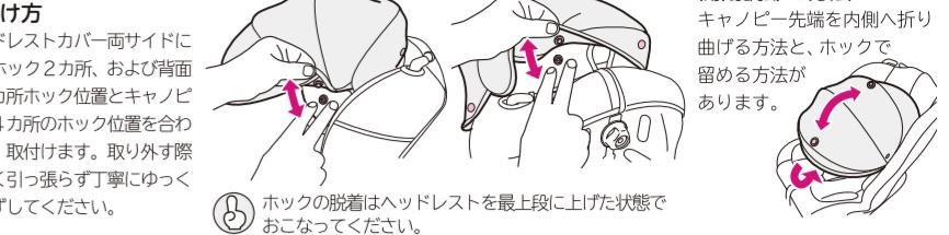
●ヘッドレストカバー両サイドにあるホック2カ所、および背面の2カ所ホック位置とキャノピーの1カ所のホック位置を合わせて、取付けます。取り外す際は、強引に張らず丁寧にゆっくりははずしてください。
